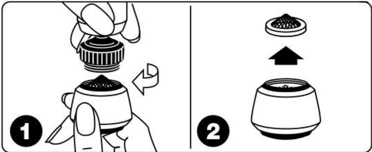
Per mantenere il rompighetto sempre in perfetta funzione, ed anche qualora il getto si presentasse irregolare, provvedere alla pulizia dell'apposita guarnizione-filtro inox.
