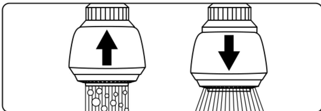
Per ottenere il cambio di funzione da aereatore a doccetta è sufficiente spingere verso il basso l'anello della testina.
