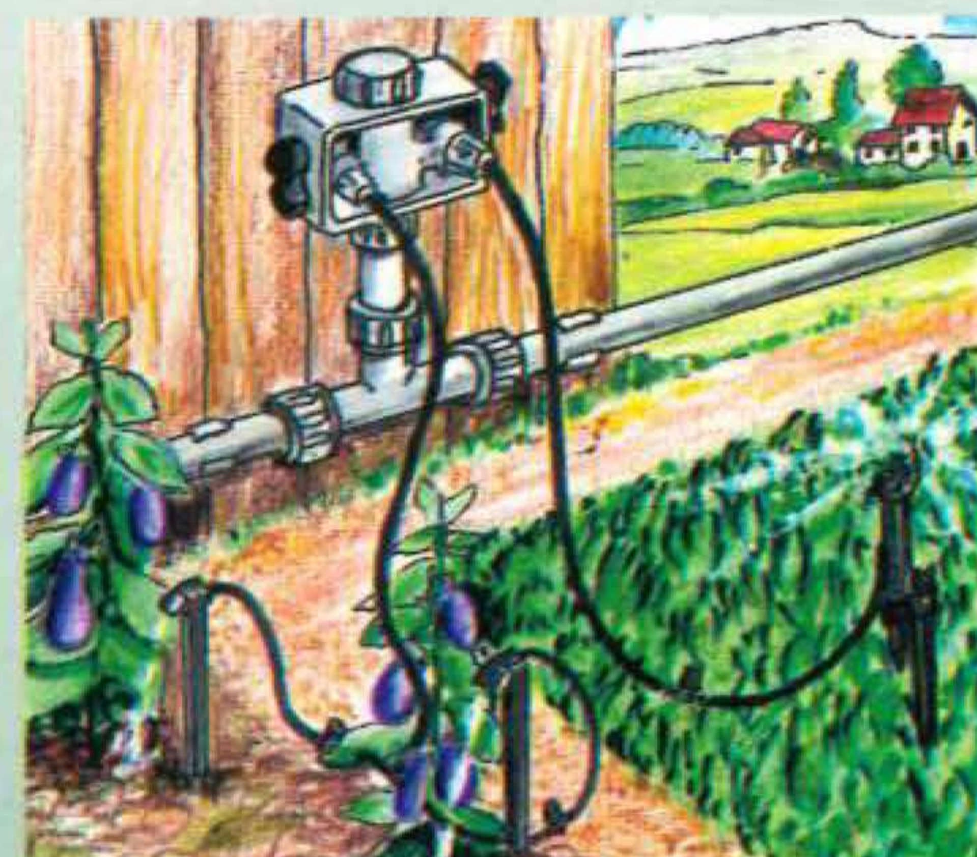
Tenere presente che nell'impianto di irrigazione capillare possono essere impiegati, contemporaneamente, i mini-irrigatori ed i micro-spruzzatori.
